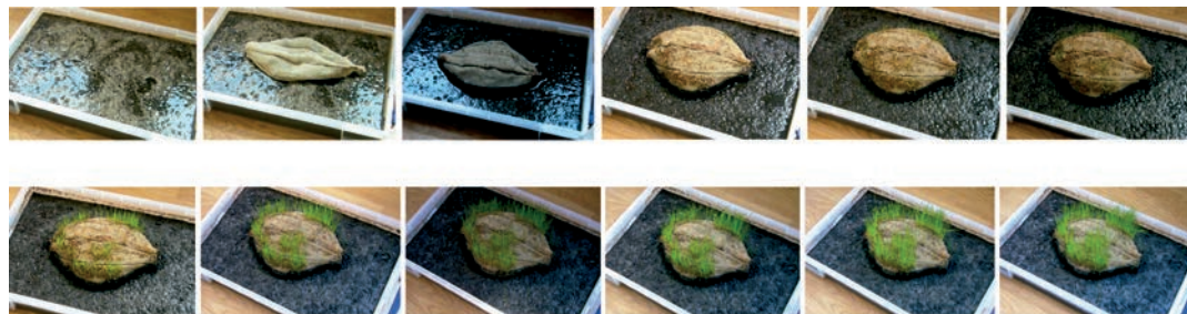
07 Performance material del componente: crecimiento inducido de vegetación en un periodo de 13 días
